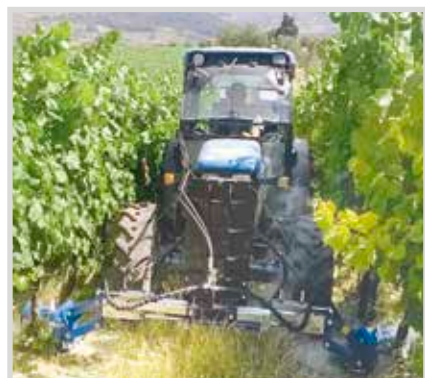
LINEA ECO GP TRATTRICE PREDISPOSTA CON BARRA INTERFILARE DOPPIA M6020312
